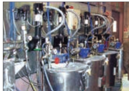
2-kuulilised 4 : 1 suhtega kolbpumbad värvimise tootmisprotsessis
