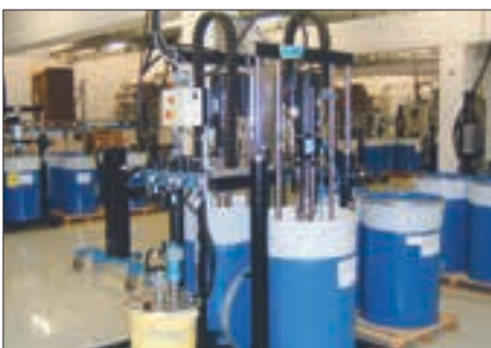
Mitme komponendi kelkudele paigaldatud 23 : 1 suhtega väljastuspumbad silikooni edastamiseks
