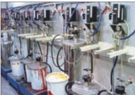
2-kuulilised 4 : 1 suhtega kolbpumbad värvimise tootmisprotsessis
