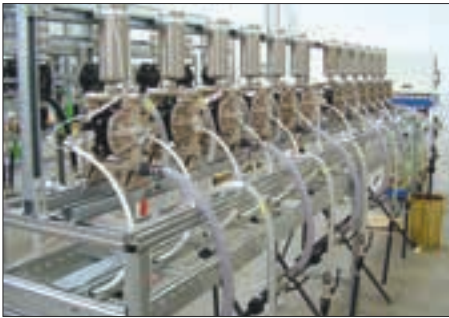
Tindi valmistamise süsteemi monteeritud ½" membraanpumbad
