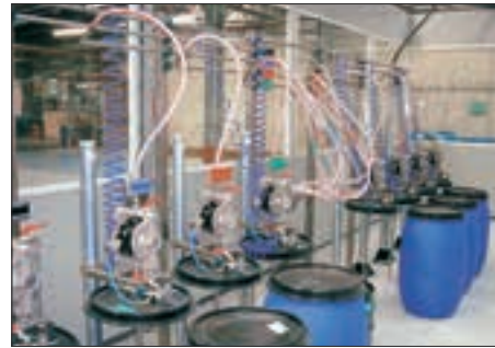
Värvimisprotsessi paigaldatud ½" membraanpumbad
