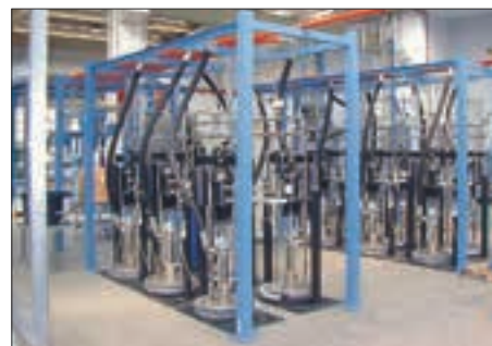
Suured 13 : 1 suhtega väljastuse kolbpumbad paigaldatud ofsettrüki tindivalmistamise süsteemi
