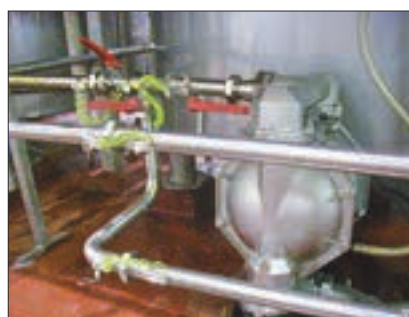
Šampoonide kosmeetilise põhja teisaldamiseks kasutatav 3" sanitaarpump
