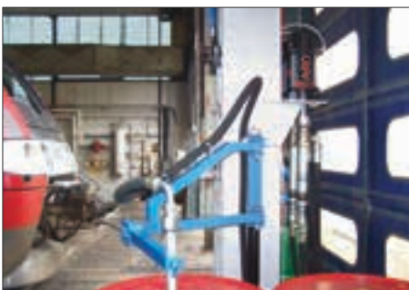
2-kuuliline 9 : 1 suhtega kolbpump kohandatud määrimissüsteemis
