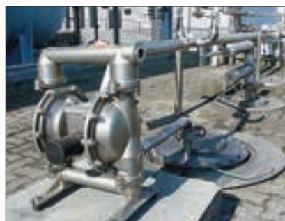
Keemilise protsessi kloriidmetüleeni edastamiseks paigaldatud 1 1/2" membraanpump
